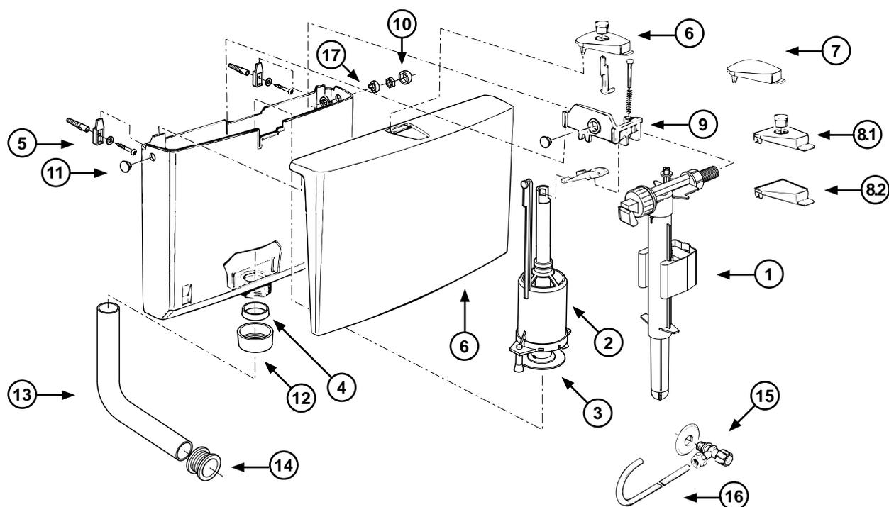
Auf Grund von Verbesserungen am WISA 500 Deckel passen die alten Drucktasten nicht mehr in den neuen Deckel. Die alten Drucktasten sind weiterhin lieferbar. Neue Deckel sind nur mit Drucktaste zu bekommen. Der neue Deckel passt auch auf ältere Spülkästen.
